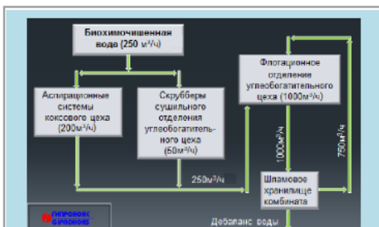
Рис. 1 Балансовая схема использования биохимически очищенной воды в водоснабжении цехов КХП АО «Евраз «ЗСМК» (Россия)
