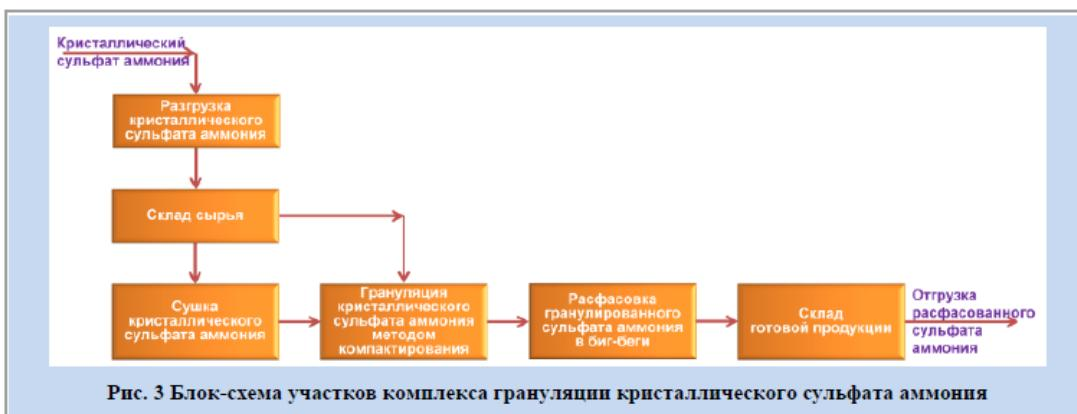
Установка предназначена для приема, хранения, грануляции мелкодисперсного кристаллического сульфата аммония методом компактирования и отгрузки потребителям железнодорожным транспортом и автотранспортом в упакованном виде или навалом.
