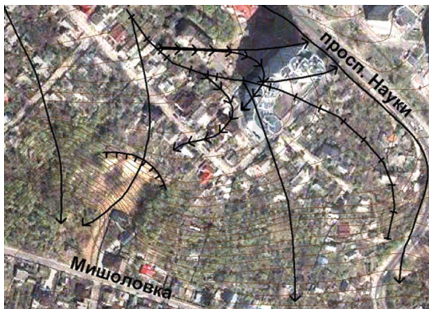
Рис. 3. Моніторинг зсуву у лівому борті Мишоловської балки а) — КЗ станом на 2002 р.; б) — КЗ станом на 2012 р.; в) — каркасні елементи рельєфу; г) — фотографія зсуву від 04. 2013 р. 1 — кільові лінії, 2 — гребеневі лінії, 3 — змінений напрям природного стоку, 4 — зсув
