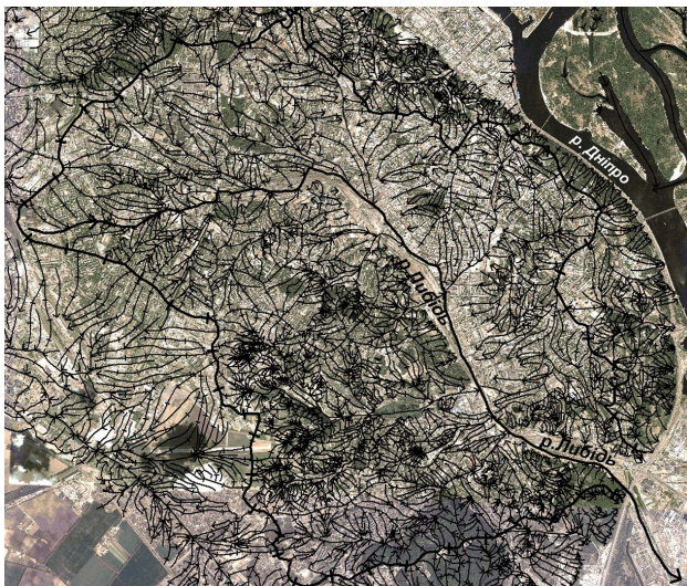
Рис. 1 А. Каркасна структура рельєфу басейну р. Либідь: 1 — кільові лінії, 2 — гребеневі лінії, 3 — кільові лінії, 4 — межі басейну р. Либідь
