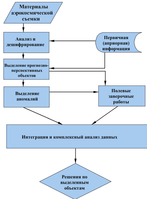
Рис. 1. Схема дистанционного поиска залежей углеводородов на суше
