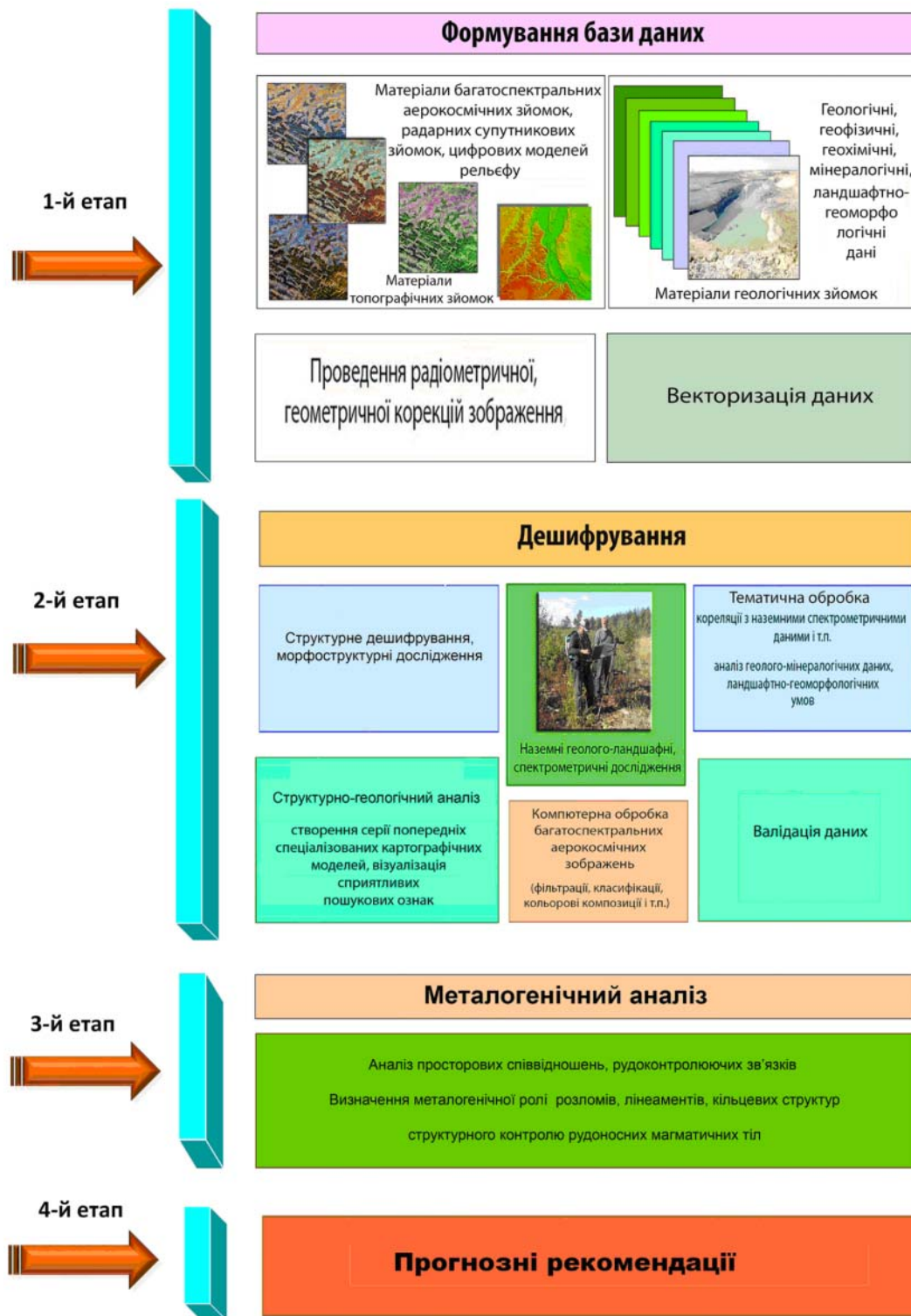
Рис. 3.1 Методико-технологічна схема пошуків рудної сировини на основі матеріалів багатоспектральних дистанційних зйомок
