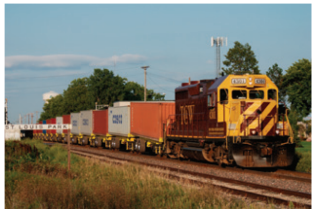
Рис. 8. Контейнерний поїзд із платформ RailRunner
