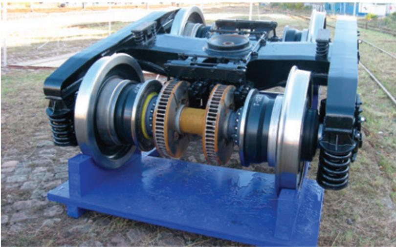
в условиях коммерческой эксплуатации на европейских линиях. В настоящее время фирмой Talgo предлагается новое техническое решение раздвижки колес применительно к тележкам грузовых вагонов. С этой целью разработана конструкция колесной пары с колесами, которые раздвигаются. Такие колесные пары устанавливаются в тележках типа В21, аналогичных тележкам У25, являющихся стандартными для грузовых вагонов колеи 1435 мм.
