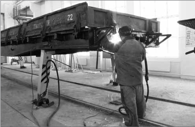
Рис. 5. Ремонт платформы в вагонном депо Котовск
