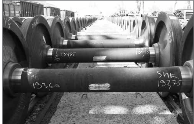
Рис. 6. Колесные пары, сформированные из старогонных осей на ВКМ Одесса-Застава I
