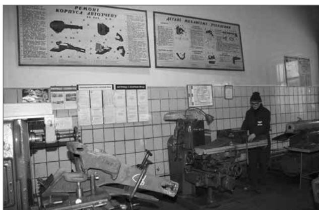
Рис. 4. Восстановление ударно-тяговой поверхности автосцепного устройства
