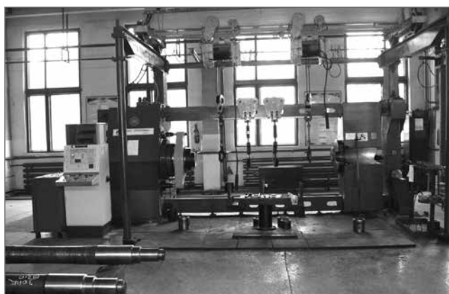
Рис. 3. Пресс для формирования колесных пар с применением старозодных осей
