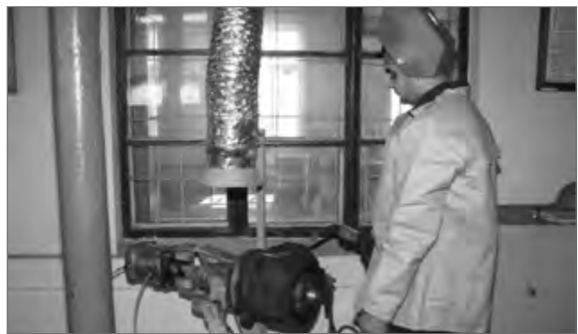
Рис. 15. Реновация буксового узла грузового вагона в ремонтном вагонном депо Знаменка
