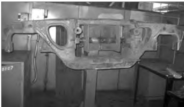
Рис. 11. Подготовка на кантователе боковой рамы грузового вагона перед восстановлением буксовых проемов
