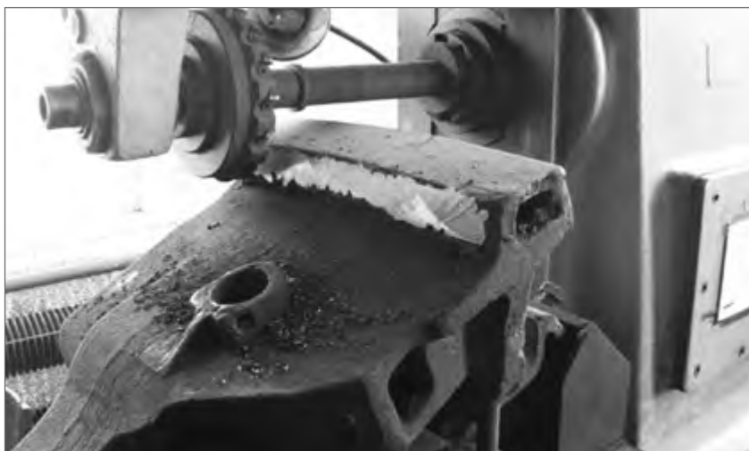
Рис. 13. Восстановление тяговой поверхности малого зуба автосцепки в ремонтном вагонном депо Шевченко
