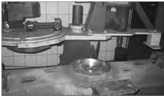
Рис. 12. Реновация подпятника наддрессорной балки грузового вагона
