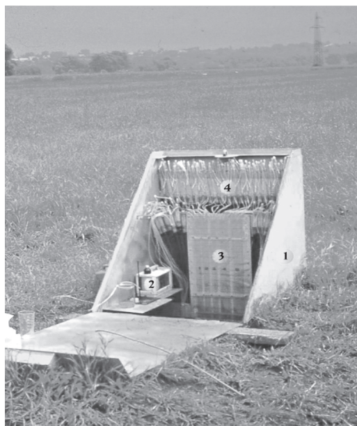
Польова тензіометрична установка: 1 — корпус шахти; 2 — самописний прилад РґВ; 3 — вимірювальний блок; 4 — блок контролю тензіометрів і дозаправки системи живлення
