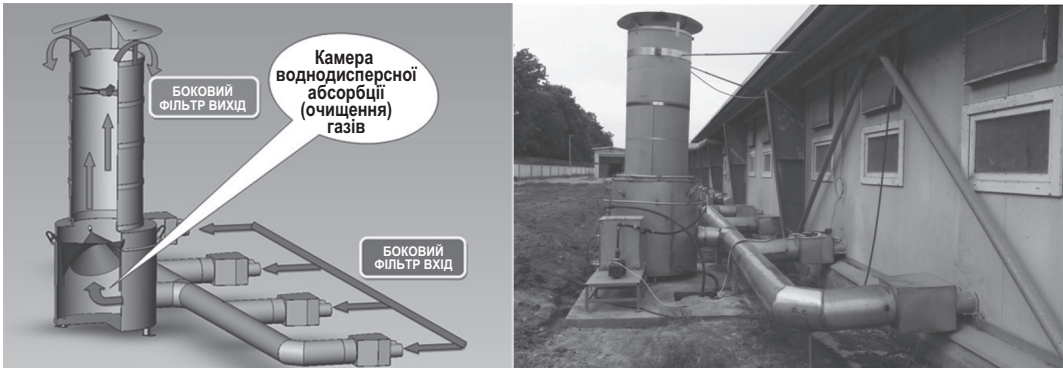
Рис. 1. Схема конструкції (зліва) та зовнішній вигляд (справа) бокової камери очищення повітря
