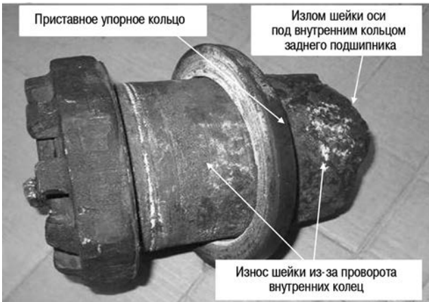
Рис. 40. Деформация приставного упорного кольца переднего подшипника
