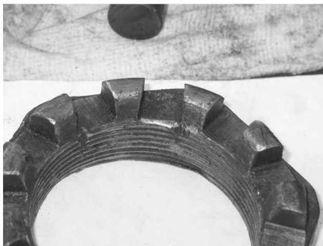
Рис. 52. Намин, образовавшийся в результате взаимодействия гайки с хвостовиком стопорной планки
