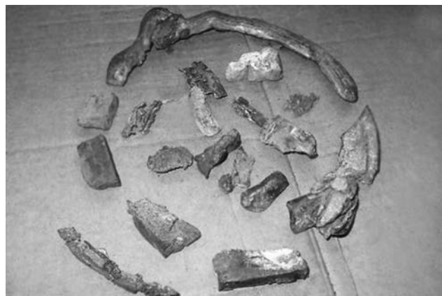
Рис. 45. Разрушение сепаратора заднего подшипника
