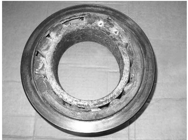
Рис. 41. Подшипник передний в сборе с внутренним кольцом, латунным сепаратором и роликами
