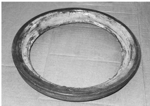
Рис. 47. Деформированный лабиринт корпуса буксы
