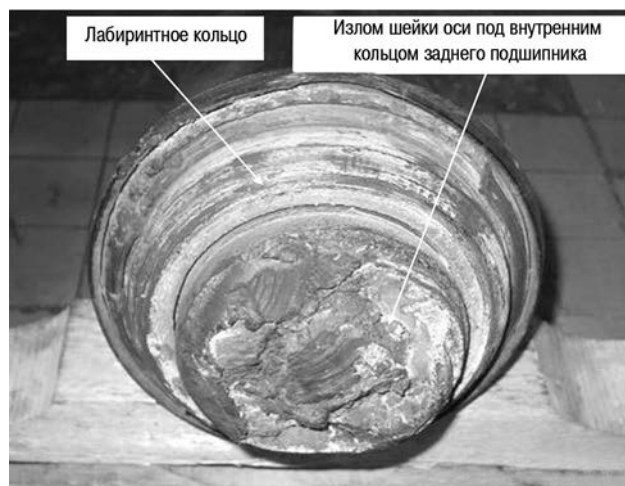
Рис. 39. Излом шейки оси
