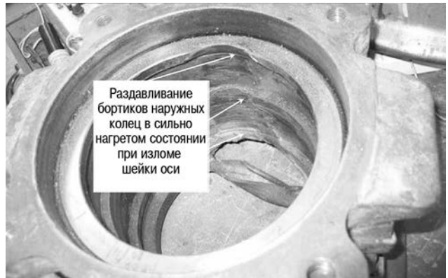
Рис. 60. Деформация корпуса буксы
