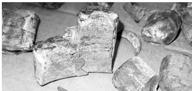
Рис. 46. Разрушенные ролики заднего подшипника
