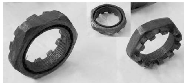
Рис. 51. Гайка М110 с выточкой
