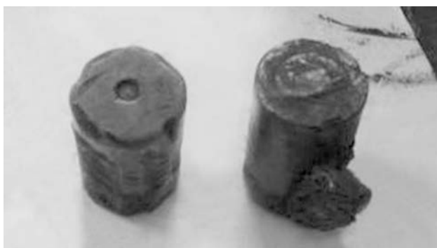
Рис. 57. Ролики, имеющие износ и сколы торцов от взаимодействия с внутренним кольцом переднего подшипника
