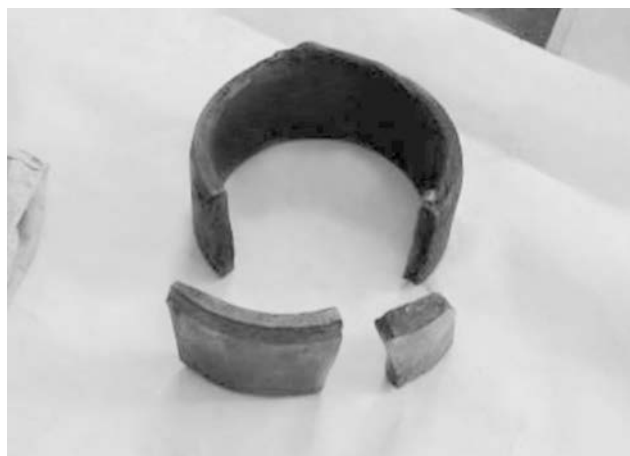
Рис. 53. Конусная фаска со следами взаимодействия с роликами заднего подшипника
