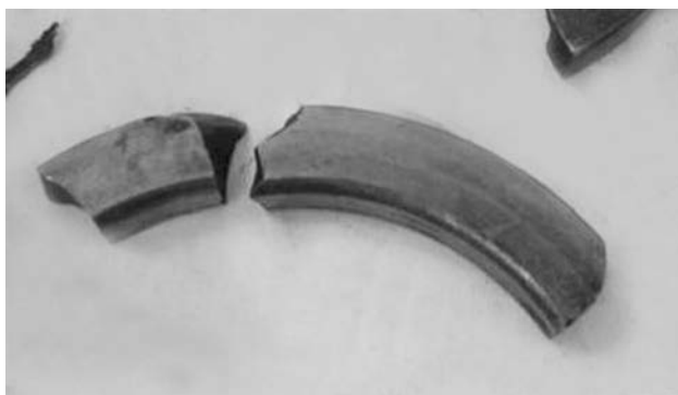
Рис. 55. Отсутствие следов проворота упорного кольца относительно гайки
