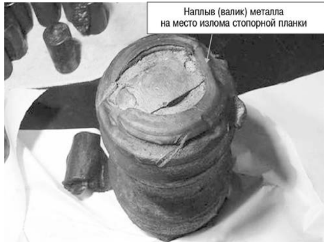
Рис. 49. Деформация торцевой части оси
