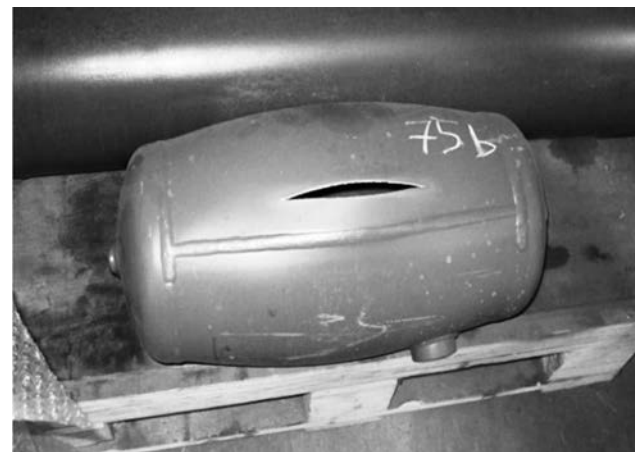
Рис. 6. Деформация и разрыв металла обечайки резервуара
