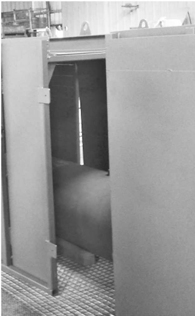
Рис. 5. Испытания резервуара с защитным кожухом
