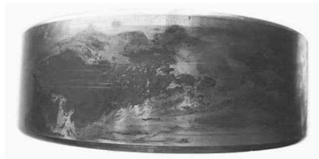
Рис. 12. Коррозия на посадочной поверхности (фреттинг-коррозия)
