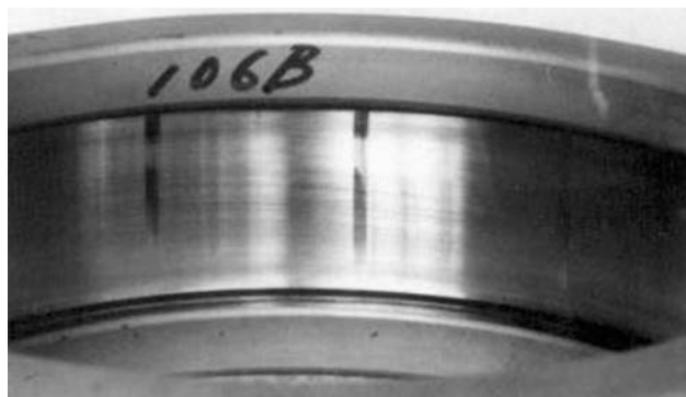
Рис. 16. Вмятины (ложное бринеллирование)
