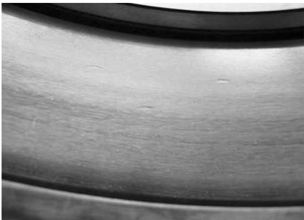
Рис. 15. Вмятины (намины) от попадания инородного твердого тела
