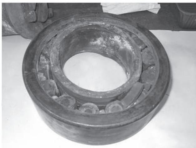
Рис. 1. Полное разрушение подшипника
