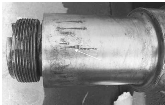
Рис. 12. Задиры на шейке оси в продольном направлении
