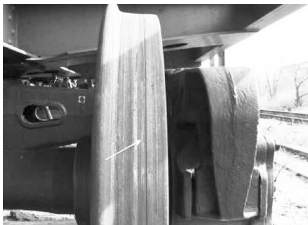
Рис. 7. Кольцевая выработка, образовавшаяся на поверхности катания колеса грузового вагона от взаимодействия его с тормозным башмаком
