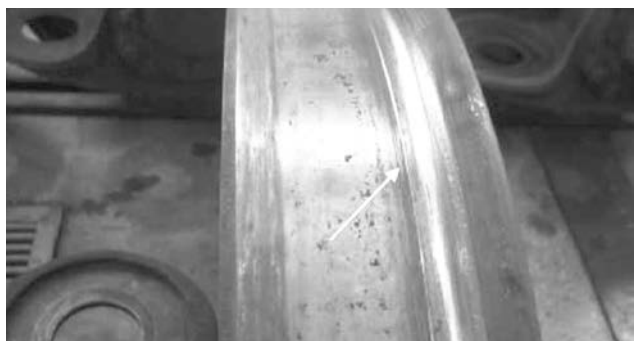
Рис. 7. Кольцевая выработка, образовавшаяся на поверхности катания колеса грузового вагона от взаимодействия его с тормозным башмаком
