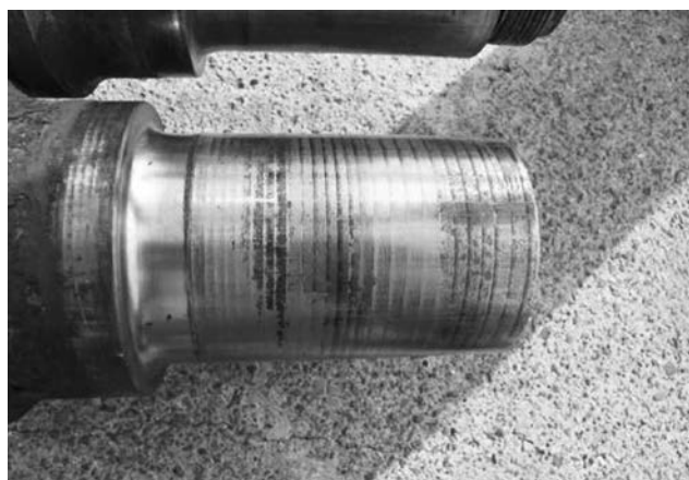
Рис. 16. Коррозионные повреждения шейки оси
