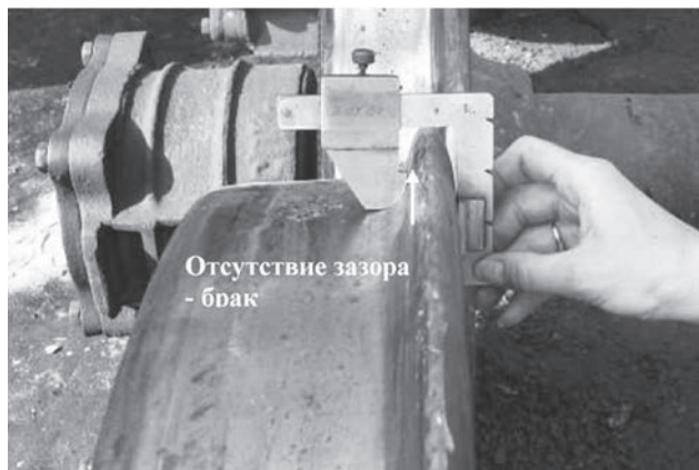
Рис. 5. Определение вертикального подреза гребня шаблоном ВПГ
