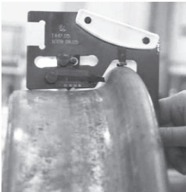
Рис. 4. Измерение толщины гребня абсолютным шаблоном
