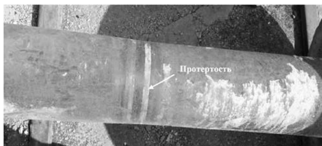
Рис. 14. Протертость на средней части оси
