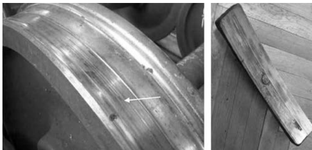
Рис. 8. Кольцевые выработки, образовавшиеся на поверхности катания колес пассажирских вагонов от взаимодействия с чугунными тормозными колодками
