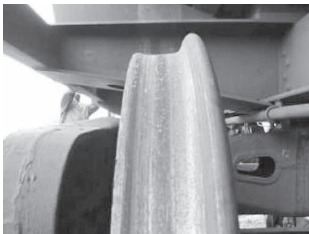
Рис. 1. Равномерный прокат колеса по кругу катания
