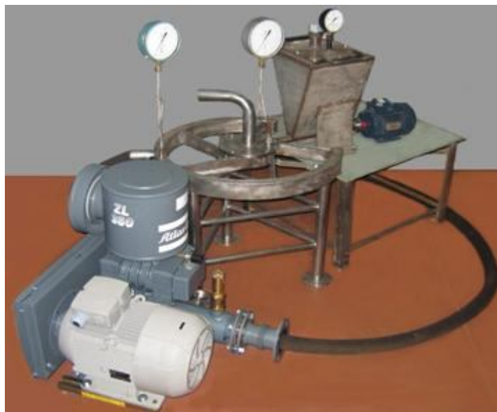
Рис. 4. Загальний вигляд експериментальної установки вихрового акустичного диспергування вугілля
