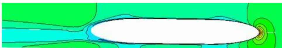
Рис. 4. Завихреність у площині XOY розрахункової області навколо корпусу швидкісного транспортного апарата
