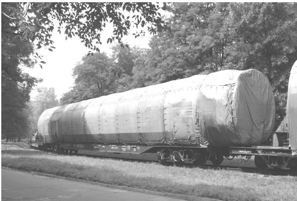
Рис. 1. Транспортирование составной части ракеты-носителя на железнодорожной секции
