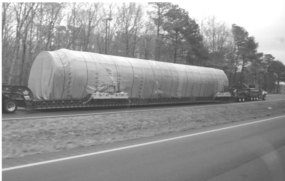
Рис. 2. Транспортирование составной части ракеты-носителя на грунтовом транспортном агрегате
