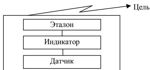
Рис. 1. Условная схема формальной структуры системы контроля времени
