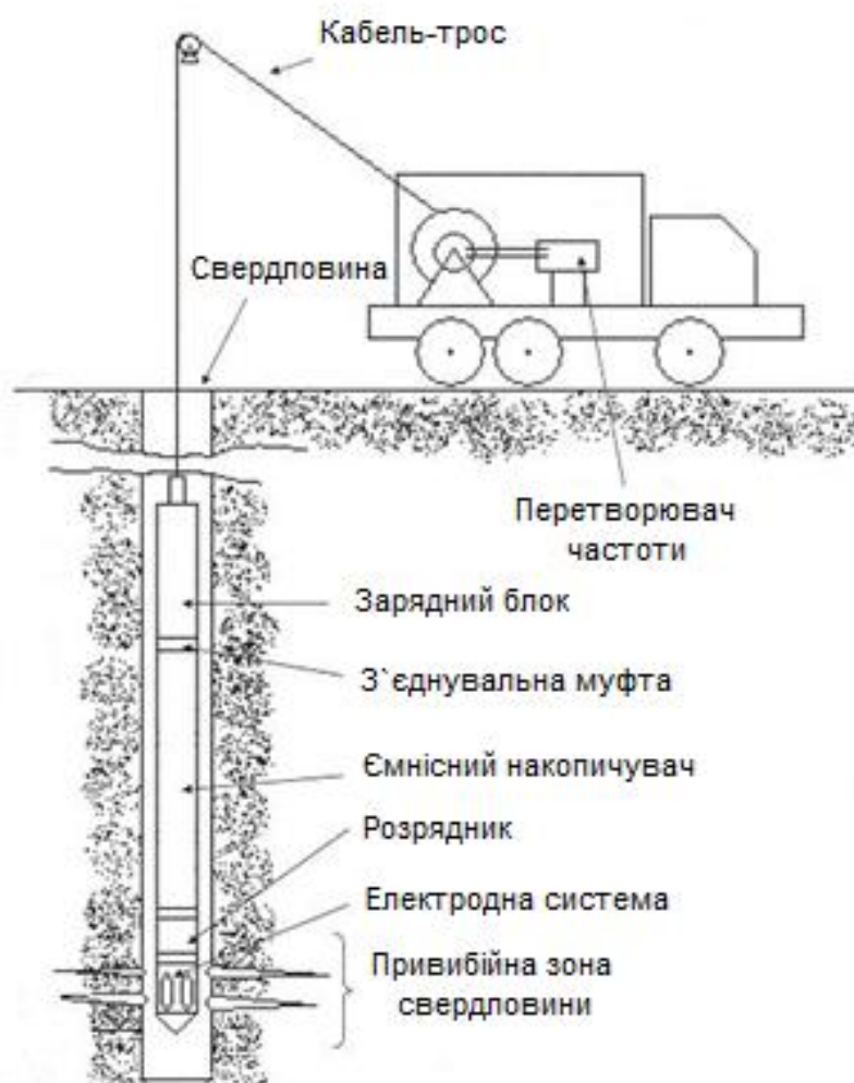
Рис. 1. Схема обробки свердловин заглибною установкою
