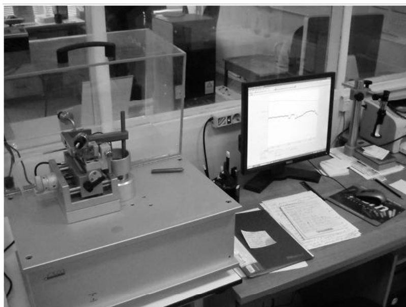
Fig. 1. Tribometer conjunction TRB – S – DE
