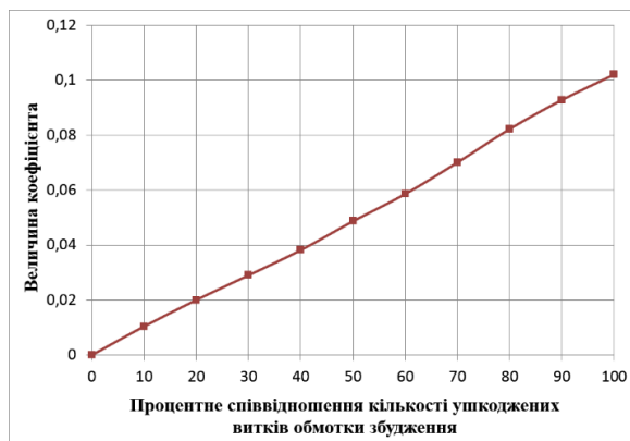
Рис. 6 – Залежність коефіцієнту обертової гармоніки від процентного співвідношення кількості ушкоджених витків на полюсі СГ
