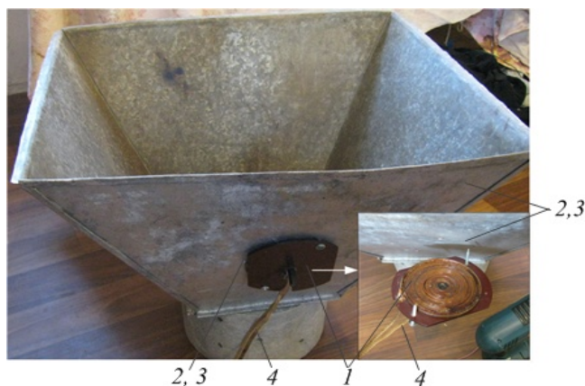
Рис. 10 – Экспериментальный макет бункера с устройством ударно-механической очистки
