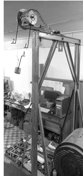
Рис. 8 – Випробувальна установка: 1 – двигун; 2 – диск; 3 – груз
