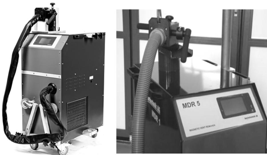
Рисунок 4 – Загальний вигляд магнітно-імпульсної установки фірми "Тесла" (гнучкий кабельний зв'язок сполучає електричний вихід установки з інструментом)
