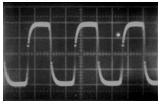
Параметри сняття осциллограмми: частота развертки - 20 кГц (длительность 5 мкс/дел); чувствительность канала вертикального отклонения - 50 В/дел
