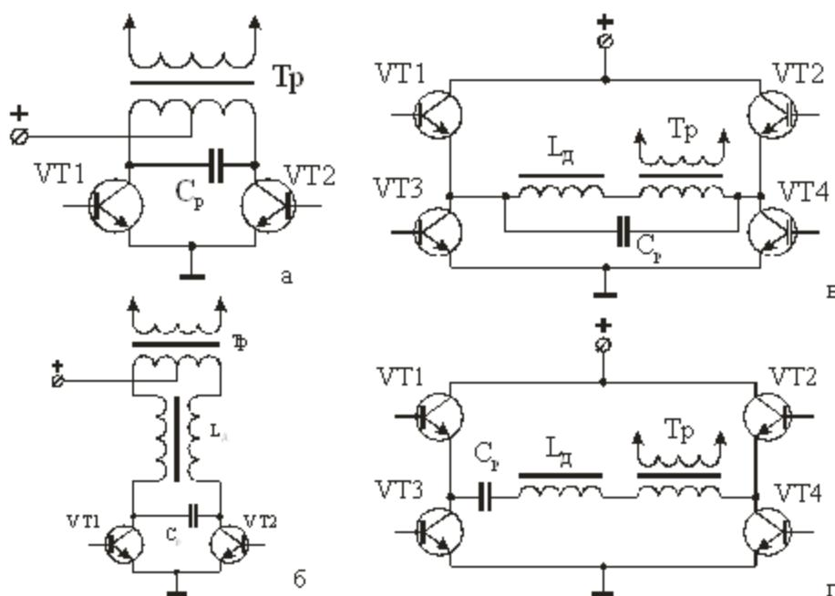
Рисунок 3 – Принципальні схеми силового блока преобразувача напруження системи рекуперації: а – двухплечевая без дополнительной индуктивности; б – двухплечевая с дополнительной индуктивностью  $L_d$ ; в) - мостовая с дополнительной индуктивностью  $L_d$  и параллельным колебательным контуром; г) - мостовая с дополнительной индуктивностью  $L_d$  и последовательным колебательным контуром
