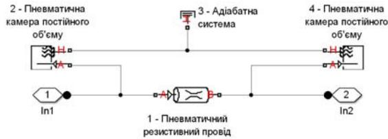
Рисунок 4 – Simscape модель пневмопроводів під маскою (поз. 7, 9, рис. 2)
