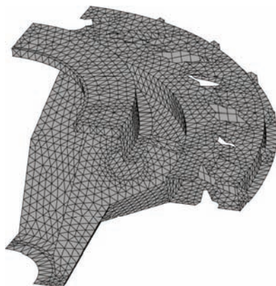
Рисунок 10 – Конечнoэлементная модель сектора крышки гидротурбины
