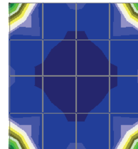
Рисунок 2 - Интенсивность напряжений \sigma_i на нижней поверхности исследуемой плиты ( t = 10 лет)
