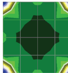
Рисунок 1 – Интенсивность напряжений \sigma_i на нижней поверхности исследуемой плиты ( t = 0 )
