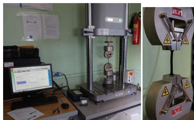
Рисунок 2 – Фіксація зразків у вимірному комплексі INSTRON E3000 для проведення циклічних тестів
