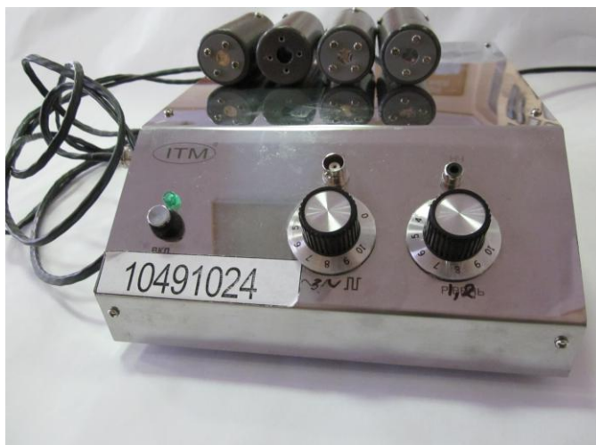
Рис. 1 – Чотириканальний аналізатор імпульсів для одночасного вимірювання альфа-, бета-, гамма- та нейтронного випромінювання
