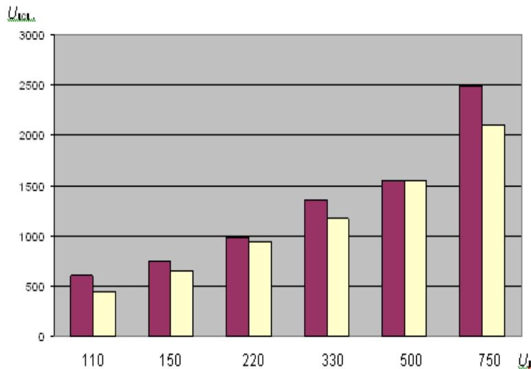
Рис. 2 Испытательные напряжения грозового импульса для полимерных изоляторов по зарубежным данным (затемнённые прямоугольники) и по ГОСТ 28856 и СОУ МПЕ 40.1.51.301
