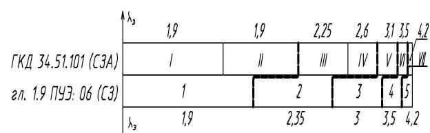
Рис. 1 Условная диаграмма количества воздушных линий (прямоугольники), проходящих по районам с различной степенью загрязнения
