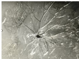
Рис. 3 – Пробой в жидком азоте ПТФЭ плёнки в центре полости (Тип 1).
