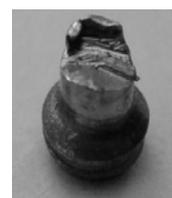
Рис. 6 – Усталостное разрушение шейки штока
