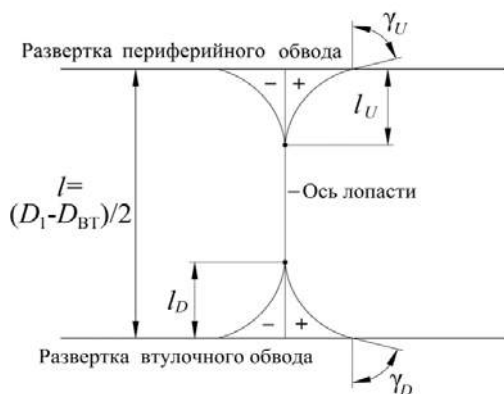
Рис. 1 – Схема сложного окружного навала лопатей РК
