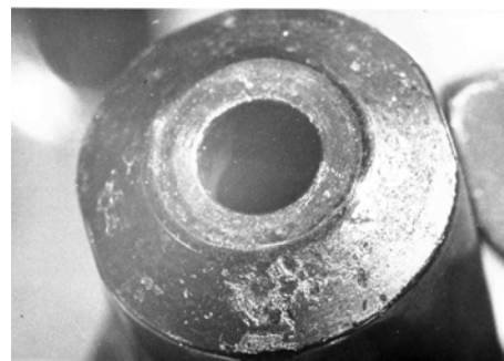
Рис. 2 – Пошкодження верхньої торцевої поверхні повзуна (якіря)
