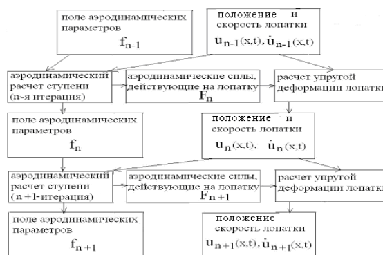
Рис.5 – Блок-схема расчета n -ой итерации аэроупругой модели
