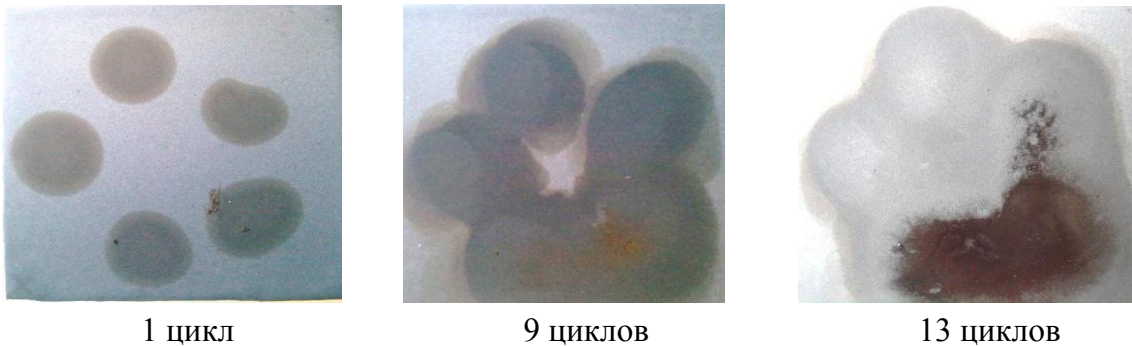
Рис. 4. Результаты испытания способности к самоочистке покрытий на основе композиции GM-30M
