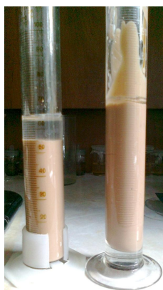
Рис. 5. Вміст колоїдної глини в різних модельних середовищах (1 – 10 % бентоніт, 2 – 10 % бентоніт + 5 % KCl, 3 – 10 % бентоніт + 5 % NH 4 Cl)
