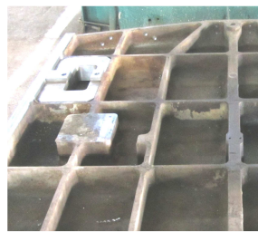
Рисунок 3 – Опорную часть рамы в месте установки колес: а – с ребрами чугунной рамы болтовыми соединениями; б – вставки из стали 09Г2С
