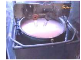
Рисунок 7 – Електролітична ванна для гальвано-плазмового перетворення алюмінієвої поверхні
