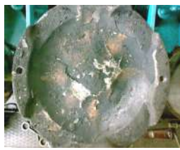
Рисунок 11 – Серійний поршень дизеля К6S310DK відпрацював 46512 мотогодин
