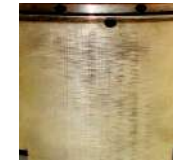
Рисунок 8 – Бокова поверхня поршня СМД після випробувань і після корундування
