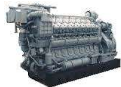
Рисунок 6 – Форсовані двигуни для установок автономного енергоживлення спеціальних об'єктів на базі модернізованих двигунів Д80
