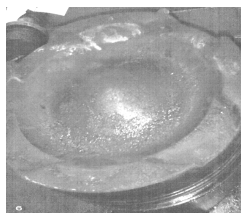
Рисунок 10 – Поршень дизеля з корундовим шаром К6S310DK відпрацював 114676 мотогодин
