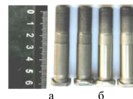
Рисунок 15 – Шатунні болти двигуна 3МЗ-406: а – у початковому стані; б – після ІБ
