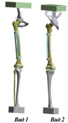
Рисунок 1 – Исследуемая геометрическая модель человеческой ноги (3-я расчетная схема)
