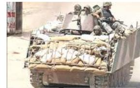
Рисунок 4 – М113 с дополнительным бронированием из подручных средств
