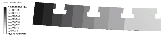
Рис. 11 – Перемещения вдоль оси Oy , м
