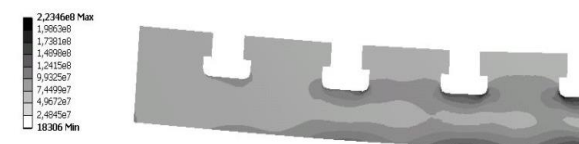
Рис. 7 – Распределение эквивалентных напряжений по Мизесу
