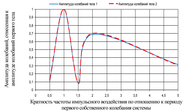
Рис. 15 – Зависимости амплитуды установившихся колебаний элементов двухмассовой системы, отнесенные к амплитуде при \alpha = 1 , от коэффициента повторности импульсов
