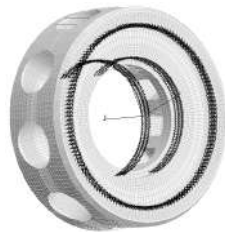
Рис. 23 – Модель закрепления корпуса насоса при действии давления в 5-ти цилиндрах
