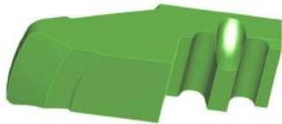
Рисунок 16 – Створення поверхні контакту з ланцюгом
