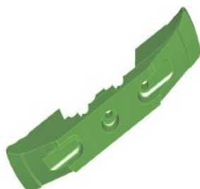
Рисунок 20 – Створення скруглень і отворів під скоби
