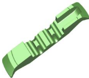
Рисунок 18 – Видалення «зайвого металу», створення двох поверхонь контакту, що залишилися, з ланцюгами
