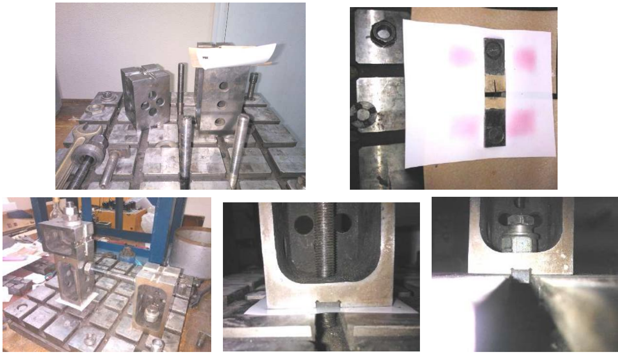
Рисунок 6 – Експериментальні дослідження елементів УЗП: робочі моменти випробувань контактної взаємодії призм УЗП із базовою плитою
