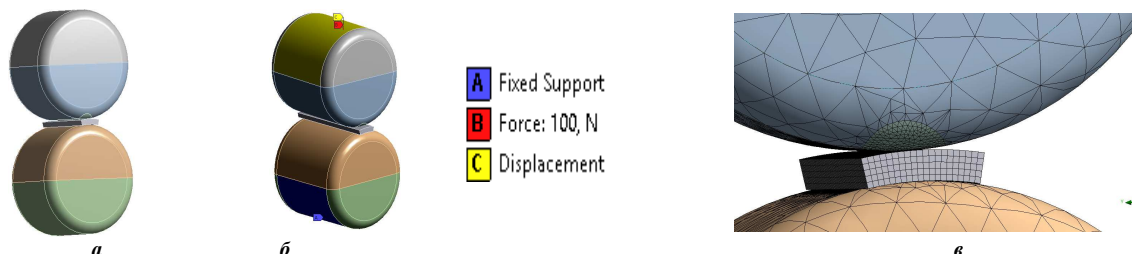
Рисунок 14 – Контакт сталевих циліндричних роликів з проміжним пружним шаром: а – геометрична модель; б – умови навантаження; в – СЕМ
